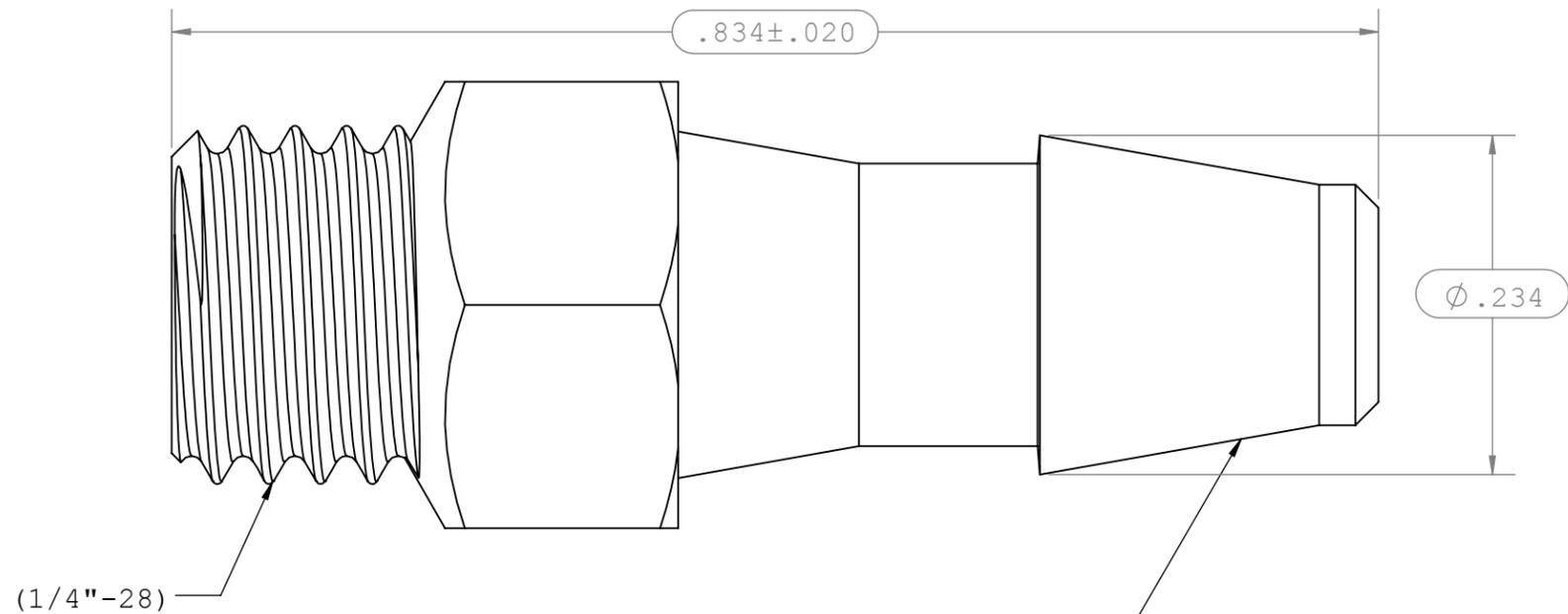
INSTRUMENT QUALITY PART. NO PARTING LINE PERMITTED ON THIS CONICAL SURFACE
